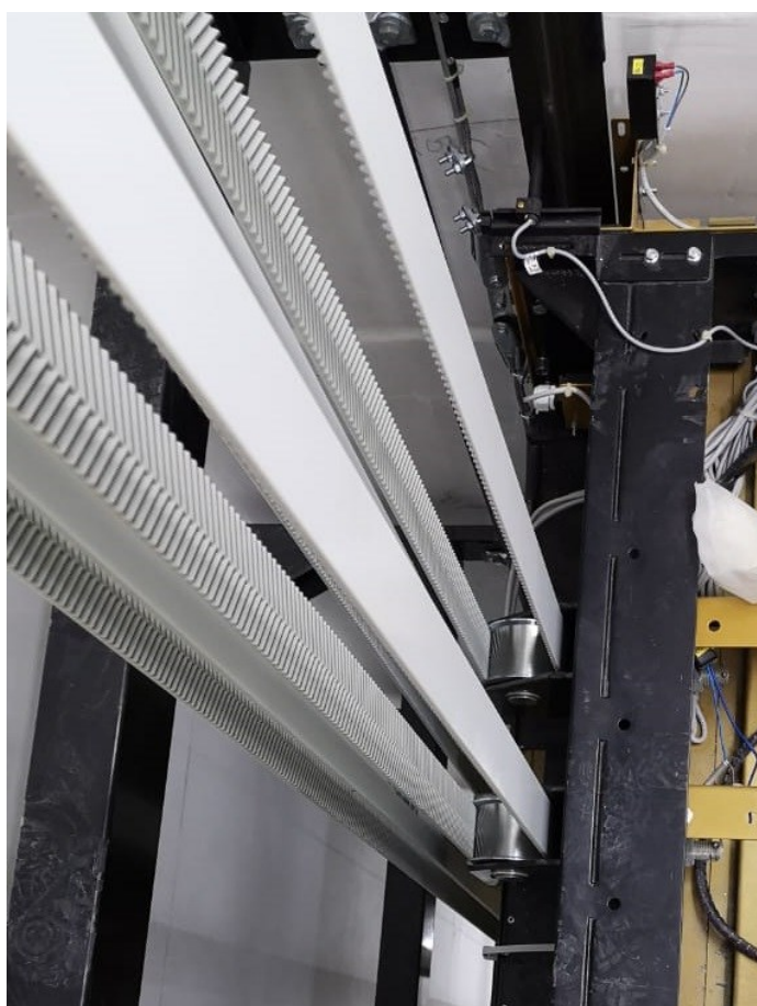
Запатентованный ременной привод лифта «GENIUS»
