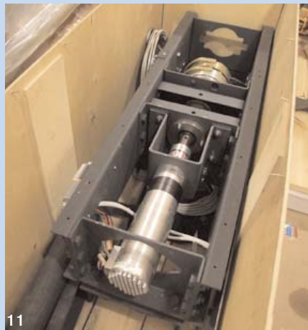
11. Рама лебёдки поставляется предварительно собранной с двигателем, комплектом КВШ и тормозом
